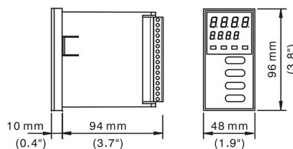
Montaje panel: taladro de 45 x 90<sup>+0,5</sup><sub>-0</sub> mm (1.8" x 3.5"<sup>+0,2</sup><sub>-0</sub>)
